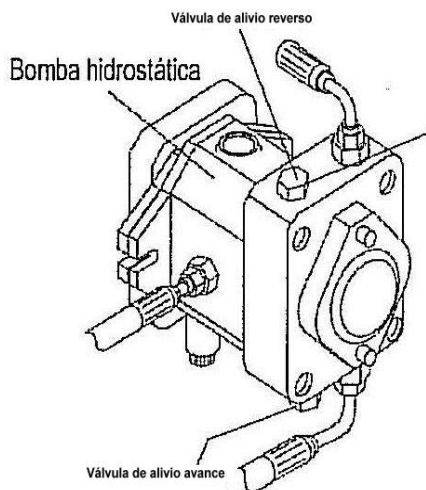
AJUSTANDO AS VÁLVULAS DE ALÍVIO DE AVANCE / REVERSO
